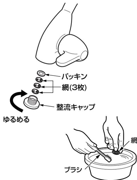
1. 工具で吐水口キャップを回して外す。
