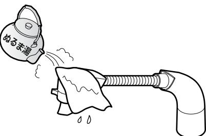
水抜きを行っても散水板の網目に付着した水滴が凍り、通水後も少しの間、水が出ない場合があります。
