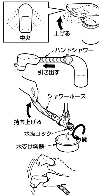
1. 配管部の元栓を閉め、水抜栓(配管部)を開ける。
