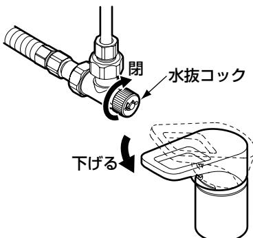
水抜コックが閉まっていることを確認し、レバーハンドルを下げて（水が出ない状態）から通水を再開してください。
