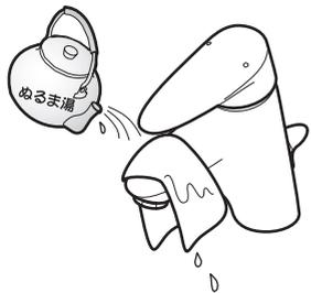
水抜きを行っても吐水口の網目に付着した水滴が凍り、通水後も少しの間、水が出ない場合があります。そのときは、タオルなどの布を巻き付け、しみこませるようにゆっくりとぬるま湯をかけてください。
