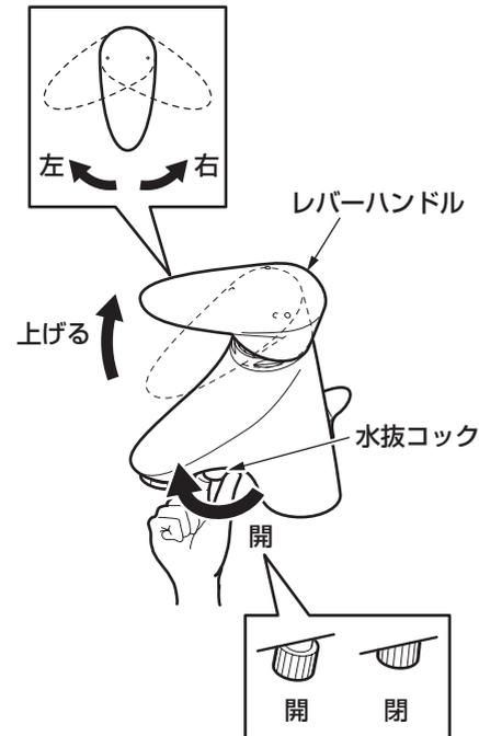
1. 配管部の水抜栓などにより通水を止めて、水抜きを行う。
