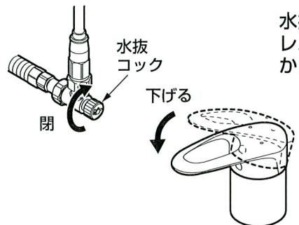
水抜コックが閉まっていることを確認し、レバーハンドルを下げる(水が出ない状態)から通水を再開してください。
