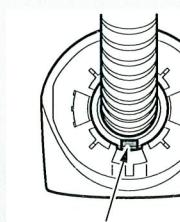
8. ハンドシャワーを引き出した状態で水を出し、ホース接続部からの水漏れがないことを確認する。
