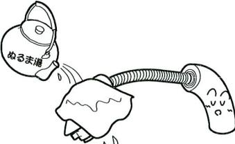
水抜きを行っても吐水口のキャップに付着した水滴が凍り、通水後も少しの間、水が出ない場合があります。そのときはハンドシャワーを引き出し、タオルなどの布を巻き付け、しみこませるようゆっくりとぬるま湯をかけてください。
