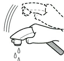
4. 水抜コックの下に水受け容器(洗面器など)を用意し、水抜コックを開ける。
