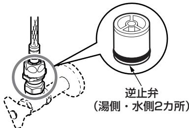
逆止弁が正常に機能しないと、状況によっては、水栓内部の湯が給水管に逆流するおそれがあります。逆流が生じた場合、給水管の破損による水漏れなどが生じる可能性があります。
