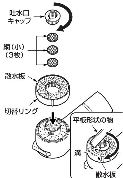
7. 切替リング・散水板・網(小)・吐水口キャップを取り付ける。
