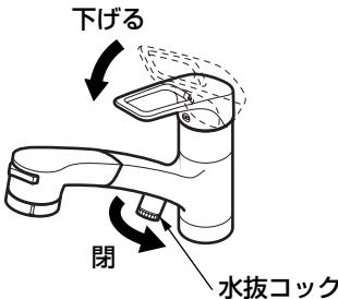
水抜コックが閉まっていることを確認し、レバーハンドルを下げる（水が出ない状態）から通水を再開してください。
