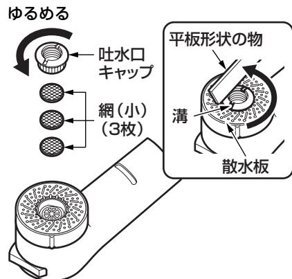
1. 平板形状の物を吐水口キャップの溝に差し込み、回して取り外す。
