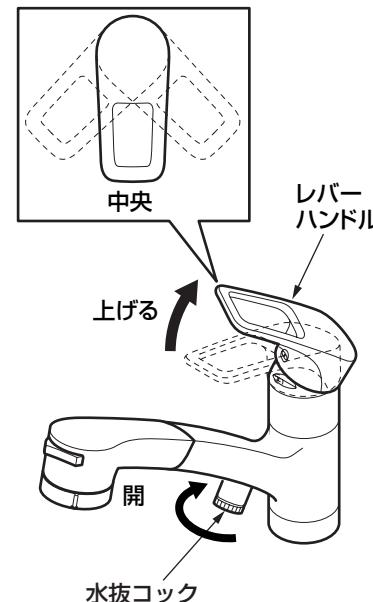
1. 配管部の水抜栓などにより通水を止めて、水抜きを行う。
