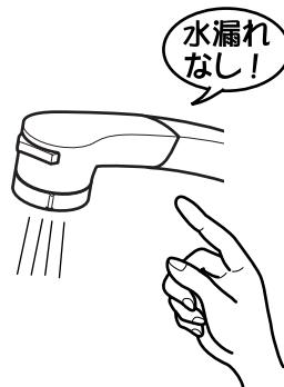
5. 掃除が終わったらフィルターを継手先端に取り付け、シャワーヘッドを継手が奥に当たるまで差し込む。
