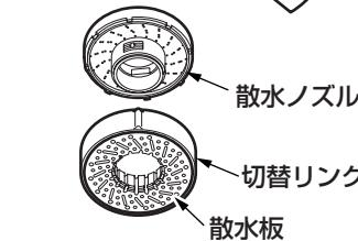
1. 平板形状の物を吐水口キャップの溝に差し込み、回して取り外す。
