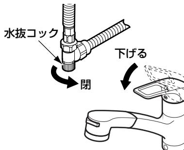
水抜コックが閉まっていることを確認し、レバーハンドルを下げて(水が出ない状態)から通水を再開してください。
