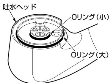
4. Oリング(小および大)を吐水ヘッドの左図の位置に組み付ける。
