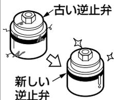
**フィルターの掃除をする際は、いきなりふたをゆるめずに、必ず止水栓または配管部の元栓を閉めてから行う**
