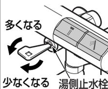
**給水圧力は給湯圧力より必ず高くするか、同圧にする**
