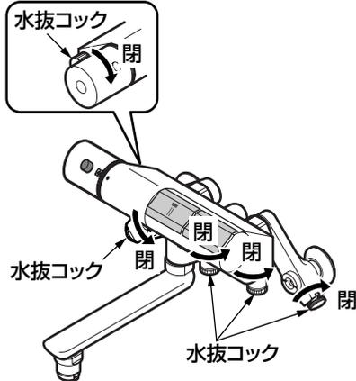
すべての水抜コック (5カ所) が閉まっていることを確認し、スパウト開閉ボタン・シャワー開閉ボタンを押して (水が出ない状態) から通水を再開してください。
