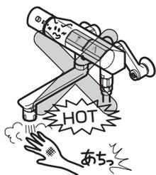
**小さい子供との入浴時や、旅行などで一時的に水栓を使用しないときには、チャイルドロックをロックし、開閉ボタンが不意に操作されないようにする**
