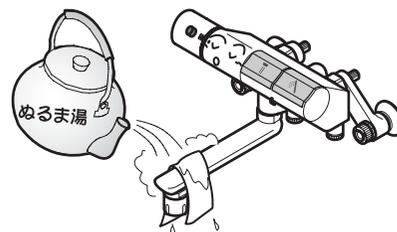
水抜きを行っても吐水口の網目やフィルターに付着した水滴が凍り、通水後も少しの間、水が出ない場合があります。そのときはタオルなどの布を巻き付け、しみこませるようにゆっくりとぬるま湯をかけてください。
