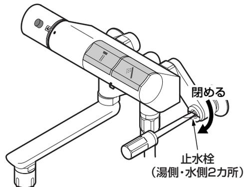
マイナスドライバーを差し込み、湯側・水側の止水栓を閉める。
