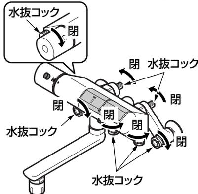
すべての水抜コック(7カ所)が閉まっていることを確認し、スパウト開閉ボタン・シャワー開閉ボタンを押して(水が出ない状態)から通水を再開してください。
