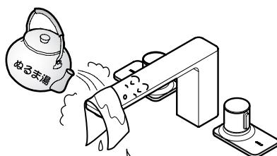
水抜きを行っても吐水口の網目に付着した水滴が凍り、通水後も少しの間、水が出ない場合があります。
