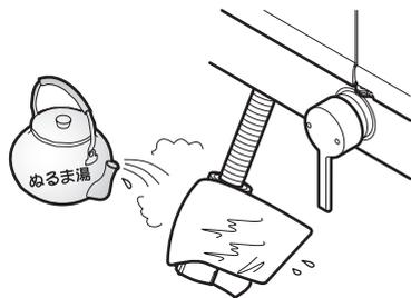
水抜きを行っても吐水口の網目や本体内部に付着した水滴が凍り、通水後も少しの間、水が出ない場合があります。そのときはハンドシャワーを引き出し、タオルなどの布を巻き付け、しみこませるようにゆっくりとぬるま湯をかけてください。
