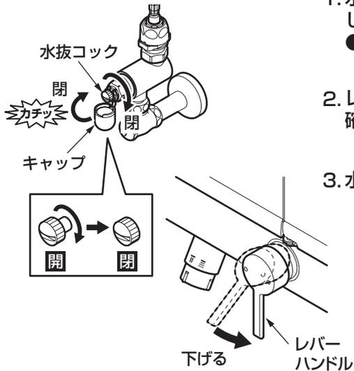
1. 水抜コックが閉まっていることを確認し、キャップをセットする。
