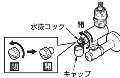
3. 水抜コックのキャップを外し、水抜コックを反時計回りに止まるまで回す。
