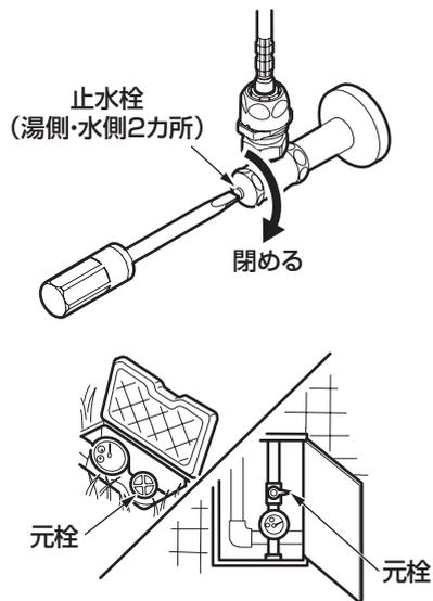
マイナスドライバーなどで湯側・水側の止水栓を閉める。
