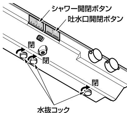
すべての水抜コック（5カ所）が閉まっていことを確認し、吐水口開閉ボタン・シャワー開閉ボタンを押して（水が出ない状態）から通水を再開してください。
