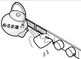
水抜きを行っても吐水口の網目やフィルターに付着した水滴が凍り、通水後も少しの間、水が出ない場合があります。そのときはタオルなどの布を巻き付け、しみこませるようにゆっくりとぬるま湯をかけてください。
