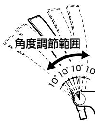
**シャワーハンガーにシャワーHEADを確実にセットして角度を変える。**
