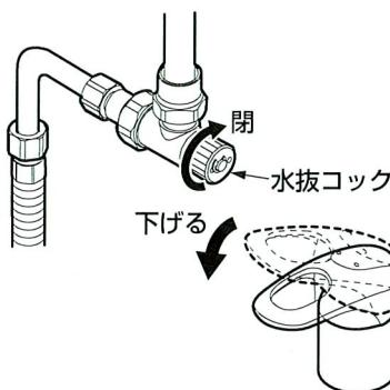
水抜コックが閉まっていることを確認し、レバーハンドルを下げて（水が出ない状態）から通水を再開してください。
