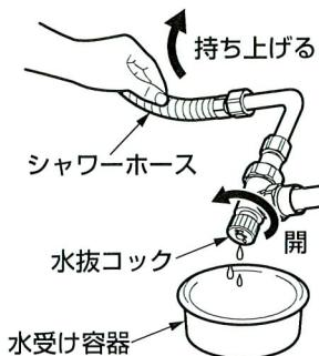
4. 水抜コックの下に水受け容器（洗面器など）を用意し、水抜コックを開ける。
