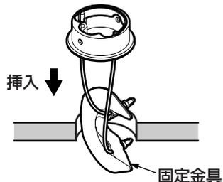
② 上面施工用アダプターの方向を合わせ、固定金具が当たるまで引き上げ部材を引き上げる。
