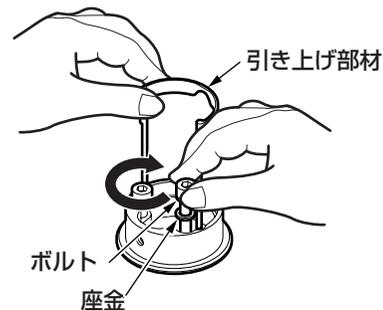
④ 引き上げ部材を戻し、上面施工用アダプターを**右図の方向に当たるまで**ずらす。
