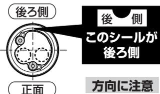
③ 引き上げ部材を引き上げたまま、ボルト・座金（2本）を手締めて仮固定する。
