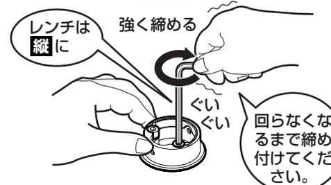
⑥ さらに六角棒レンチを横にして**左右交互に**しっかり締め付け、確実に固定する。
