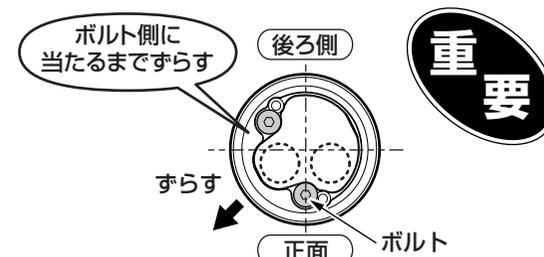
⑤ ボルトに六角棒レンチを縦に差し込み、**左右交互に強く締め付ける**。
