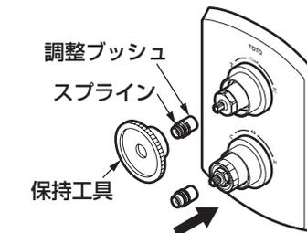
4. 保持工具が回らないように手で押さえて、六角穴付きボルトを強く締め付けて固定する。
