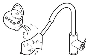
水抜きを行っても吐水口の網目や本体内部に付着した水滴が凍り、通水後も少しの間、水が出ない場合があります。そのときはハンドシャワーを引き出し、タオルなどの布を巻き付け、しみこませるようにゆっくりとぬるま湯をかけてください。
