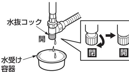
③ 水抜コックの下に水受け容器（洗面器など）を用意し、水抜コックを開ける。
