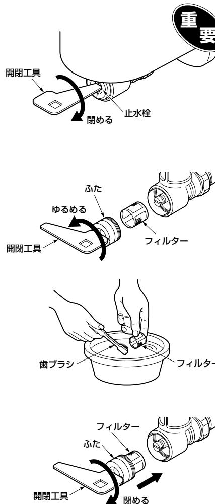
1. 開閉工具で止水栓を閉める。
