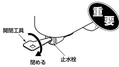
1. 開閉工具で止水栓を閉める。
