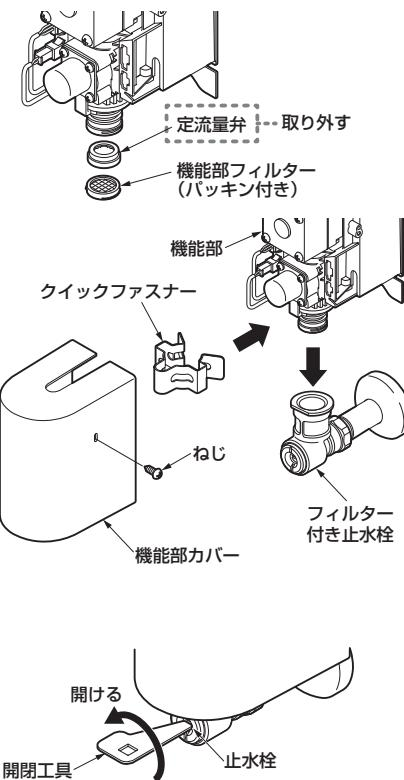
5. 機能部に組み込まれている機能部フィルター(パッキン付き)を取り外し、定流量弁を取り外す。
