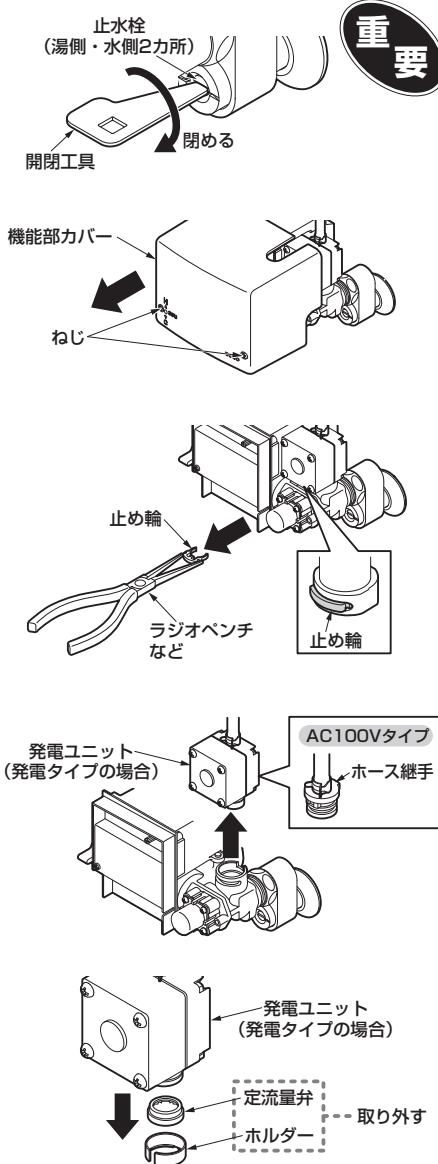
1. 開閉工具で湯側・水側の止水栓を閉める。
