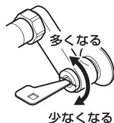
3. 安全ボタンを押しながら、温度調節ハンドルを上 (湯側) いっぱいに回し、2.と同じように湯側止水栓で流量を調節する。
