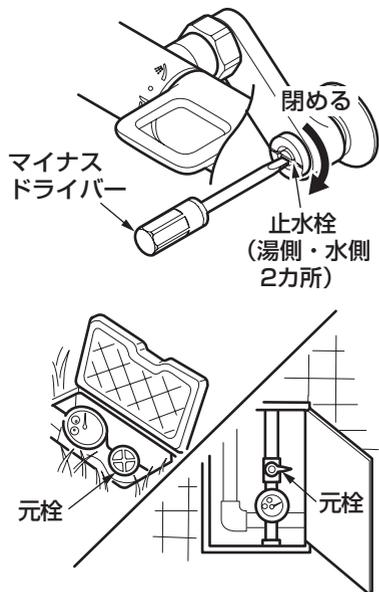
マイナスドライバーを差し込み、止水栓を閉める。
