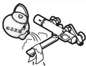
水抜きを行っても吐水口の網目やフィルターに付着した水滴が凍り、通水後も少しの間、水が出ない場合があります。そのときはタオルなどの布を巻き付け、しみこませるようにゆっくりとぬるま湯をかけてください。
