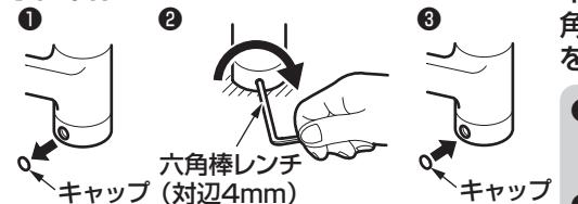
キャップまたはインデックスを外し、六角棒レンチ(対辺4mmおよび3mm)を使用してねじを締めなおす。
