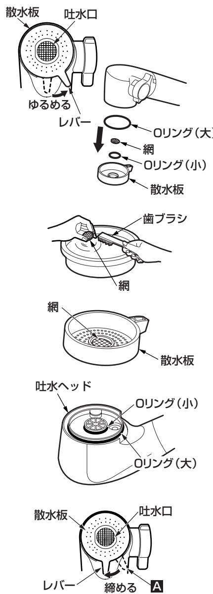
1. 散水板のレバーに指をかけ、反時計回りに回し、散水板を取り外す。
