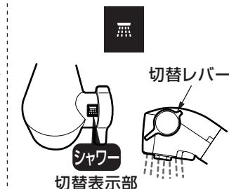
切替レバーを回して、切替表示部を「」にあわせると、水道水のシャワーが出ます。
