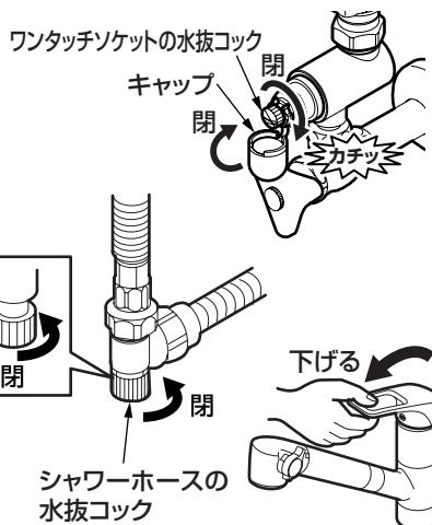
すべての水抜コック（3カ所）が閉まっていること、またキャップがセットされていることを確認し、浄水カートリッジを取り付けてください。
