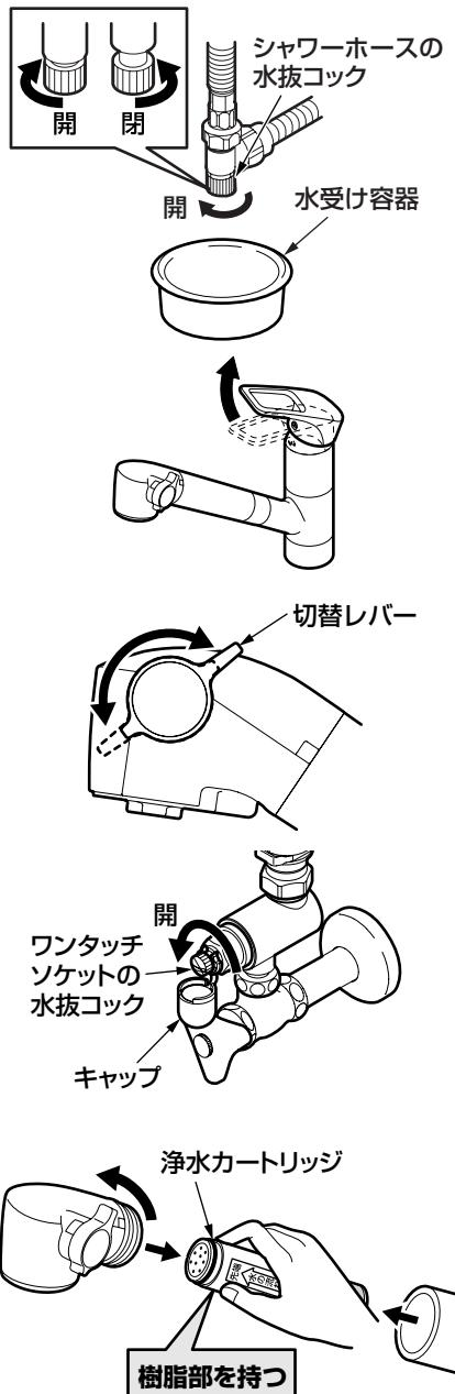
4. シャワーホースの水抜コック(1力所)の下に水受け容器(洗面器など)を用意し、シャワーホースの水抜コックを開ける。
