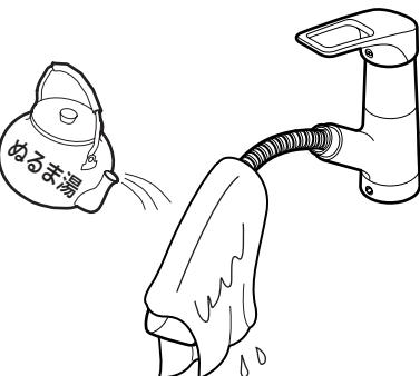
水抜きを行っても散水板の網目やフィルターに付着した水滴が凍り、通水後も少しの間、水が出ない場合があります。
