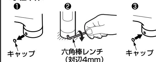
キャップまたはインデックスを外し、六角棒レンチ(対辺4mmおよび3mm)を使用してねじを締めなおす。
