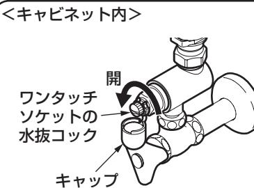
4. 水抜コックの下に台拭きなどを用意し、水抜コックを開ける。
