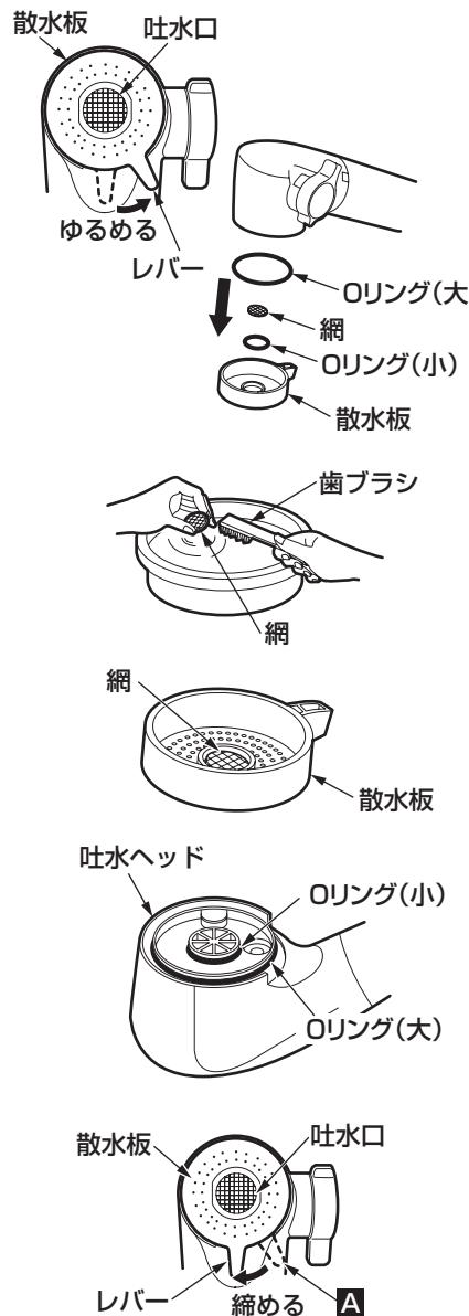
1. 散水板のレバーに指をかけ、反時計回りに回し、散水板を取り外す。
