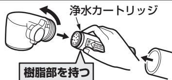
1. 浄水カートリッジを抜き取り、清潔なビニール袋などに入れて凍結しない場所に保管する。
