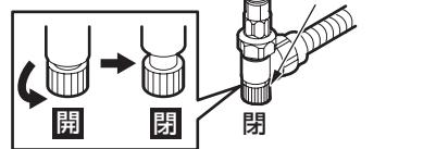
8. 水が抜けたら、レバーハンドル・水抜コックを閉める。
