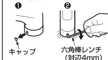
キャップまたはインデックスを外し、六角棒レンチ(対辺4mmおよび3mm)を使用してねじを締めなおす。
