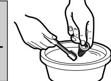
→ フィルター・吐水口・散水板の掃除をする。
