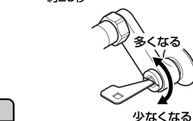
4. 安全ボタンを押しながら、温度調節ハンドルを上(湯側)いっぱいに回し、3.と同じように湯側止水栓で流量を調節する。
