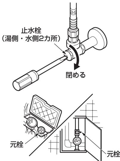
マイナスドライバーなどで湯側・水側の止水栓を閉める。
