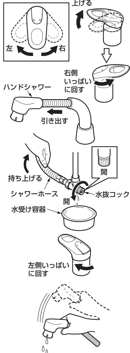
1. 配管部の水抜栓などにより通水を止めて、水抜きを行う。
