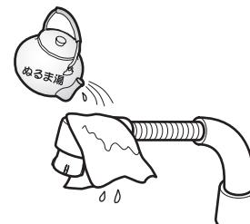
水抜きを行っても吐水口の網目やフィルターに付着した水滴が凍り、通水後も少しの間、水が出ない場合があります。
