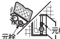
**新築・改修工事後や水道断水復旧後は、必ず配管内の空気を抜く**
