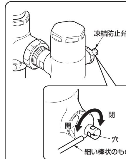
凍結防止弁の穴に細い棒状のものを差し込んで、反時計回りに回す。
