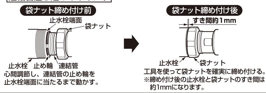
⑧心間調節完了後は工具を使ってすべての接続部を確実に締め付ける。
