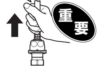
施工後、万が一ホースを外した場合は、「ワンタッチソケット」の説明札を確認のうえ、必ずワンタッチソケットとホース内の残水を抜いてからホースを差し込んでください。
