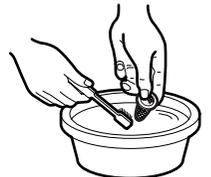
↳ フィルター・吐水口・散水板の掃除をする。
