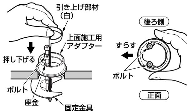
⑤ボルトに六角棒レンチを縦に差し込み、**2本のボルトを交互に**強く締め付ける。
