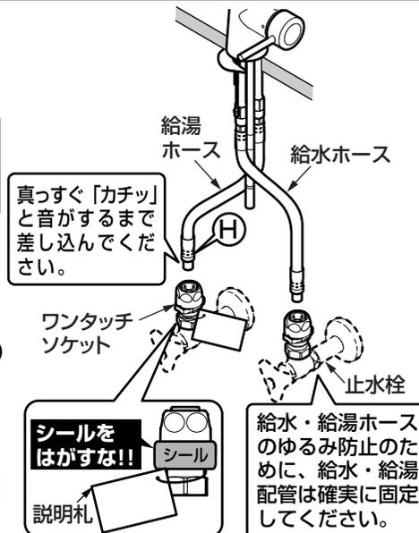
給水・給湯ホースのゆるみ防止のために、給水・給湯配管は確実に固定してください。
