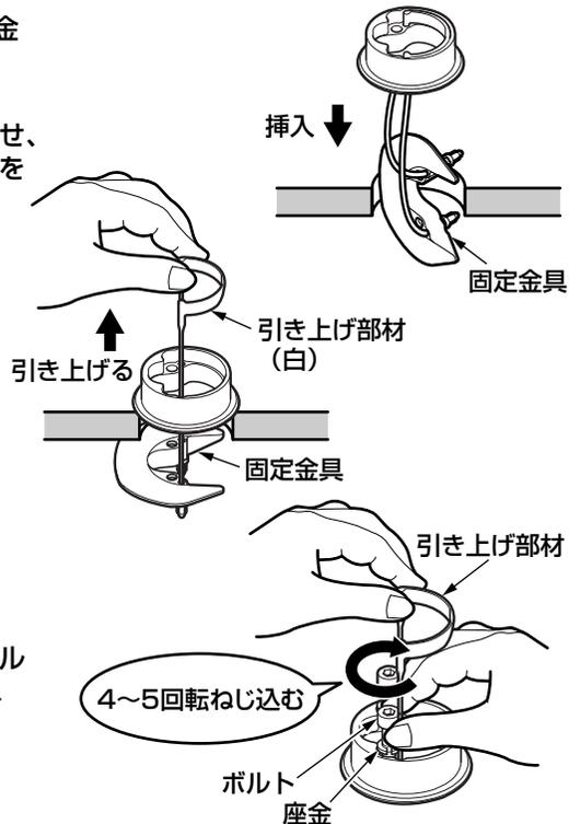
③引き上げ部材を引き上げたまま、ボルト・座金（2本）を固定金具に通し、手締めで4~5回転ねじ込む。
