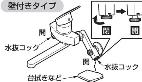
2. 水抜コックの下に台拭きなどを用意し、水抜コックをすべて開ける。
