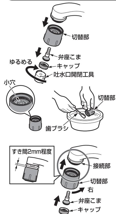
1. 付属の吐水口開閉工具をキャップの切り欠きに差し込み、回して外す。
