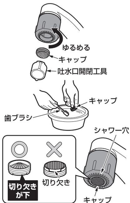
1. 付属の吐水口開閉工具をキャップの切り欠きに差し込み、回して外す。
