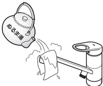
水抜きを行っても吐水口の網目に付着した水滴が凍り、通水後も少しの間、水が出ない場合があります。そのときはタオルなどの布を巻き付け、しみこませるようにゆっくりとぬるま湯をかけてください。
