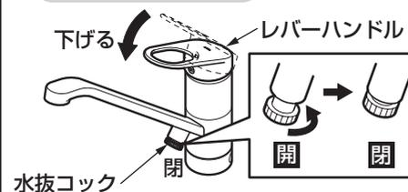
4.水が抜けたら、レバーハンドル・水抜コックを閉める。(水抜き完了)
