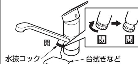
2.水抜コックの下に台拭きなどを用意し、水抜コックをすべて開ける。
