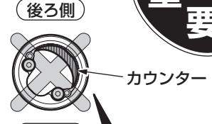
カウンターが見える状態で上面施工用アダプターを固定しないでください。
