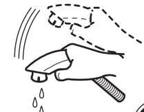
8. 水抜き完了後は、必ず水抜コックを閉め、レバーハンドルを下げる。(水が出ない状態)
