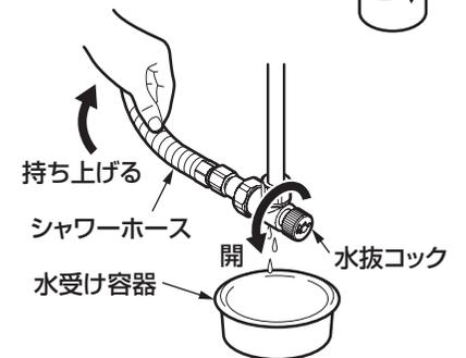
4. 水抜コックの下に水受け容器(洗面器など)を用意し、水抜コックを開ける。
