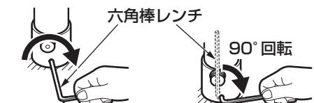
⑤六角棒レンチの横方向で、約90°回して確実に締め付ける。
