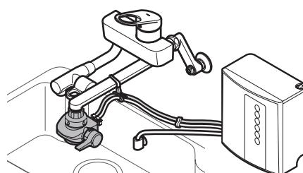
**3. 先端分岐金具または浄水器を取り付ける。**
