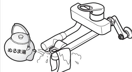
吐水口の網目に付着した水滴が凍り、通水後も少しの間、水が出ない場合があります。
