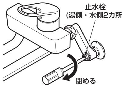
マイナスドライバーを差し込み、湯側・水側の止水栓を閉める。
