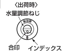
②合印をあわせたあと、ハンドルを操作して確実に洗浄できるか確認する。
