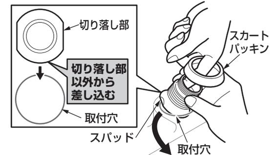
③ スパッドと陶器の間にスカートパッキンを押し込み、スパッドに組み込む。
