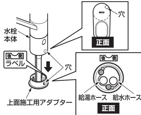
②水栓本体固定ねじを仮止め工具で仮固定する。
