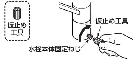
③水栓本体が正面に取り付けられているか確認する。正面に取り付けられていないときは、水栓を取り外して、上面施工アダプターの位置（向き）を調整してください。（②②を参照）
