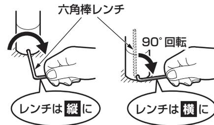
⑤六角棒レンチの横方向で、約90°回して確実に締め付ける。
