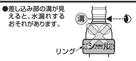
施工後、万一ホースを外す場合は、説明札の「**ホースの取外方法**」・「**ホースの再接続**」を確認してから外してください。
