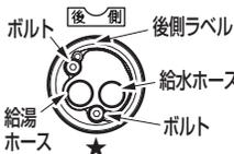
・後側ラベルの反対側のボルト★が正面になります。
