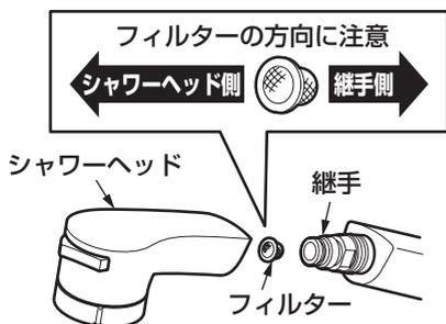
5. 掃除が終わったらフィルターを継手先端に取り付け、シャワーヘッドを継手が奥に当たるまで差し込む。
