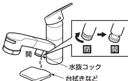
2.水抜コックの下に台拭きなどを用意し、水抜コックを開ける。
