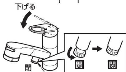
4. 水が抜けたら、レバーハンドル・水抜コックを閉める。
