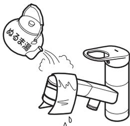
水抜きを行っても吐水口の網目に付着した水滴が凍り、通水後も少しの間、水が出ない場合があります。
