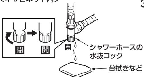
3. 水抜コックの下に台拭きなどを用意し、水抜コックを開ける。
