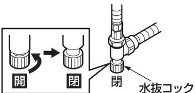
6. 水が抜けたら、レバーハンドル・水抜コックを閉める。(水抜き完了)
