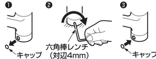
キャップまたはインデックスを外し、六角棒レンチ(対辺4mmおよび3mm)を使用してねじを締めなおす。
