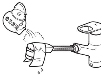
水抜きを行っても散水板の網目やフィルターに付着した水滴が凍り、通水後も少しの間、水が出ない場合があります。そのときは、ハンドシャワーを引き出し、タオルなどの布を巻き付け、しみこませるようにゆっくりとぬるま湯をかけてください。
