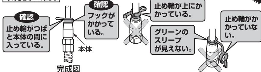
施工後完成図どおりになっていることを確認ください。正しく施工していないと、しばらくして水漏れが発生することがあります。
