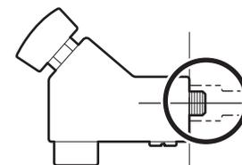
水漏れがある場合は、配管に腐食・ひび割れなどがないことを確認のうえ、再度取り付け直してください。
