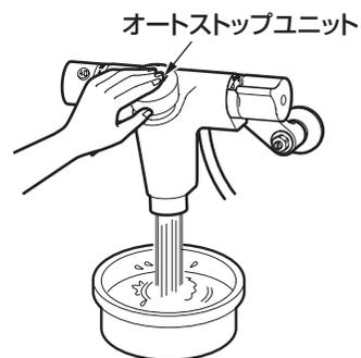
4. お好みの量に調節し、取り外しと逆の手順で取り付ける。
