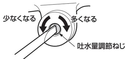
3. オートストップユニットの吐水口用ボタンを一度押して吐水量を確認する。
