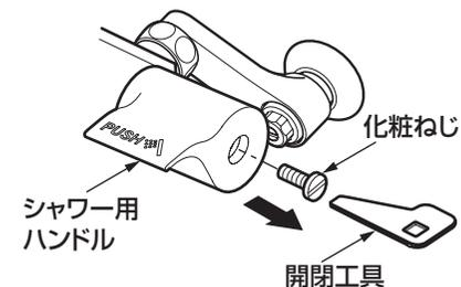
2. 化粧ねじの穴よりマイナスドライバーを差し込み、吐水量調節ねじを回す。
