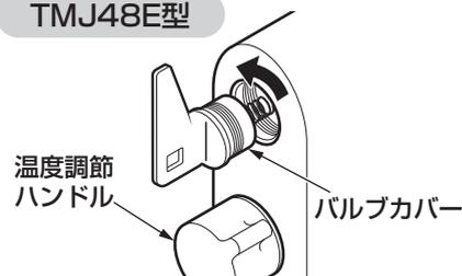
1. マイナスドライバーで湯側・水側の止水栓を閉める。
