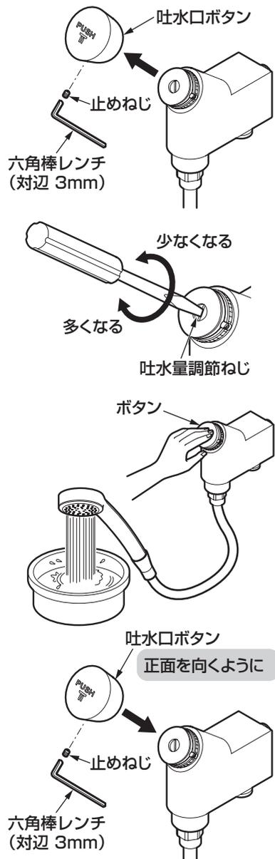
1. 止めねじをゆるめて吐水口ボタンを引き抜き、取り外す。
