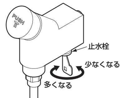
**止水栓の流量調節ねじを回す。**
