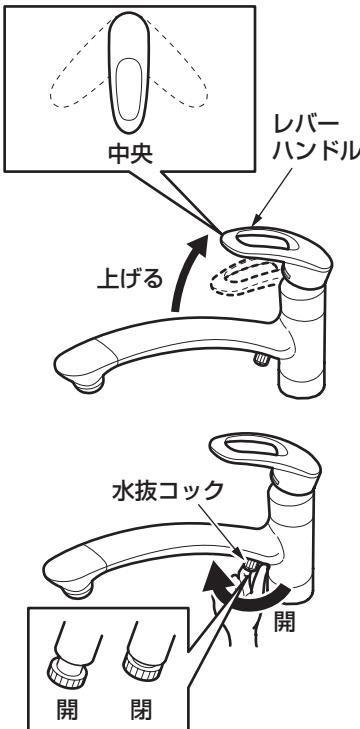
1. 配管部の水抜栓などにより通水を止めて、水抜きを行う。
