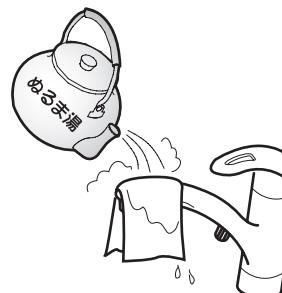
水抜きを行っても吐水口の網目に付着した水滴が凍り、通水後も少しの間、水が出ない場合があります。
