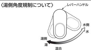
このカートリッジは湯側いっぱいにハンドルを回しても 必ず湯に水が混ざるように設定されているため、ハンド ルのセンター位置に対し、湯側と水側の回転角度が異 なります。
