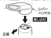
②下向きにレバーハンドルをカートリッジに押しつけ ながら新しい止めねじを締め付ける。
