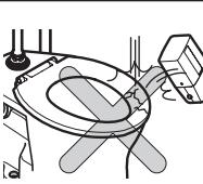
**ピストンの掃除をする際は、いきなりピストンを取り出さずに、止水栓または元栓を閉めてから行う（取扱説明書を参照してください）**
