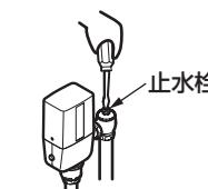
**取付接続部に腐食・ひび割れ・水漏れなどのないことを十分に確認のうえ、取り付ける**
