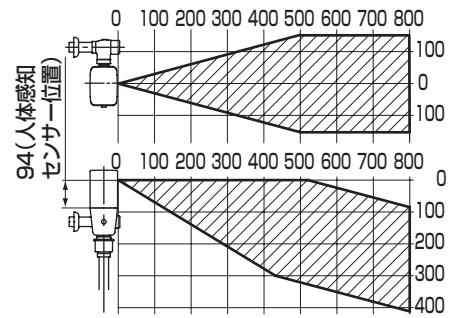
B. 光電センサー正面の壁がステンレスなど反射やすい場合や、光電センサー同士が対向する場合
