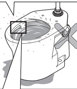
**8. 止水栓を開き、手動洗浄ボタンを押しながら巡回水の高さが適切になっていることを確認する。水圧が高い場合など、水勢が強すぎて水があふれる場合は、便器の水位ラベルを確認のうえ、止水栓を調節してください。**
