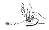
⑥モーターレンチなどの工具を使用して 締付ナットを確実に締め込む。
