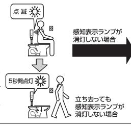
感知距離を自動調整します。3分以上、障害物を感知すると自動的に距離を調節しますのでお待ちください。 それでもトイレブースの壁や便器を感知する場合は、感知距離の再設定が必要となります。
