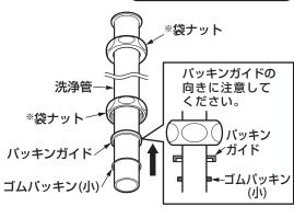
①洗浄管に\*袋ナット(2個)、パッキンガイド、ゴムパッキン(小)を挿入する。
