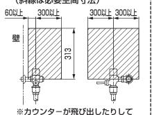
B. 光電センサー正面の壁がステンレスなど 反射しやすい場合や、光電センサー同士 が対向する場合
