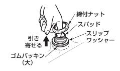
⑤あらかじめ指に締付ナットを通し、スパッドを取付穴の中心で引き寄せ、締付ナットを手で締め込む。
